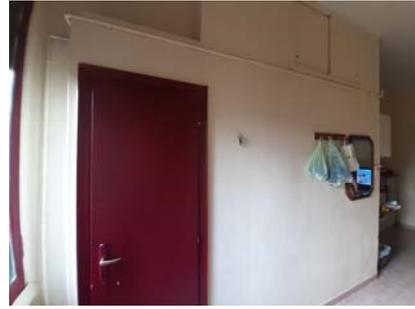
Regolarizzazioni: mediante presentazione di pratica edilizia a sanatoria per regolarizzazione della modifica rilevata (con verifica delle superficie e dei rapporti aeroilluminanti dei locali). Dovrà essere realizzato divisorio interno al bagno per creare disimpegno. Sarà probabilmente necessario richiedere all'ASL deroga in quanto l'attuale larghezza del bagno è inferiore alla misura minima richiesta dal Regolamento Edilizio.
